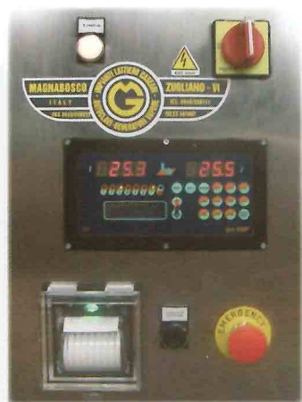
Pannello elettrico con plc e stampante (opzionale) Electrical panel with plc and printer (optional)
