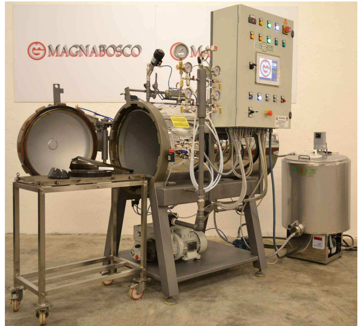
Autoclave Ø 650 x 1000 a 15 BAR a 250 °C Completa di impianto di raffreddamento acqua a circuito chiuso e carrello porta vassoio.
